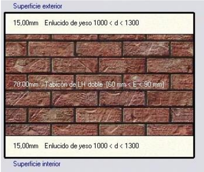
Composición capa a capa de Tabiquería (H2)
