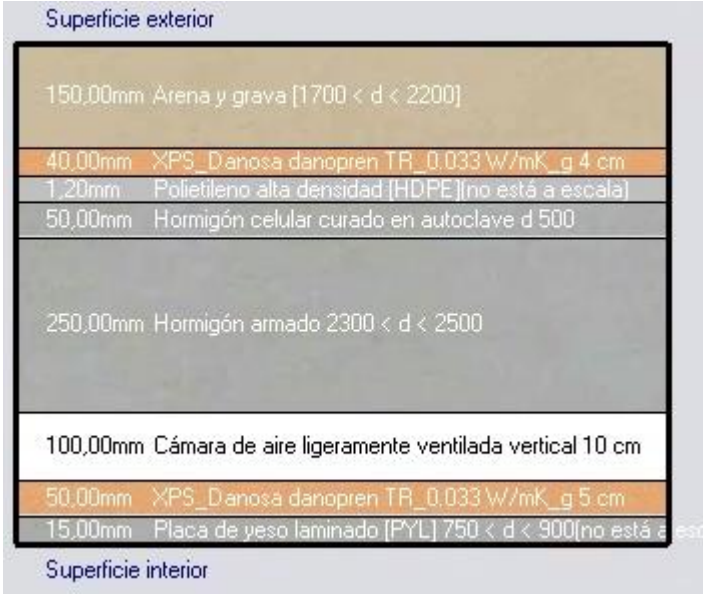
Composición capa a capa de Cubierta Invertida (H4)
